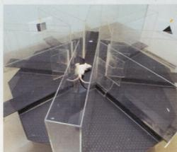
8方向放射状迷路装置。8本の放射状に伸びたアクリル製アームの先端に小さな餌を隠し、空腹したラットがそれを獲る行動を利用する。訓練したラットは、8個の餌を8回の侵入で獲るようになるが、アルツハイマー病や脳血管性認知症を被験させるとそれができなくなる。これを防ぐ薬を探すために行動実験を行います。
