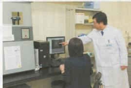
生体内の遺伝子やたんぱく質の動きを化学発光で捕らえる装置「Fluor Chem」。この装置で、アルツハイマー病の細胞の中で何が起きているかを調べます。
