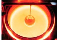
**FZ法:** 種単結晶の上に垂直に立てた多結晶Si棒の一部を高周波で局部的に加熱して溶かし、この熔融層を種単結晶から上部に少しずつ移動させることで結晶全体を単結晶化する。
