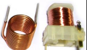
**コアコイル:** フェライト(酸化鉄系セラミックス)等の強磁性体を芯に持つコイル。内部のコアを上下に動かし、インダクタンスの値を調整できるもの(半固定型)もある。
